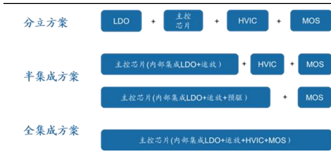
图21: 公司分立、半集成、全集成架构方案示意图
