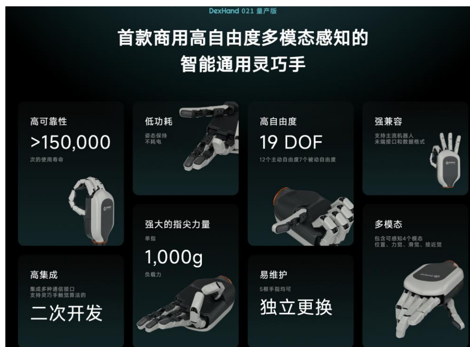
图23：灵心巧手 DexHand 量产版循环寿命大于 15 万次。
