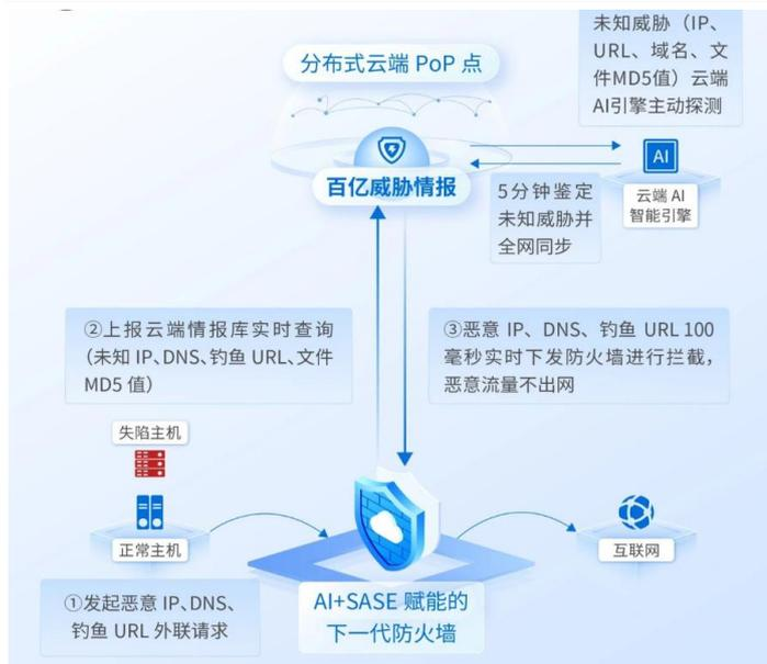
图 27：内联云端架构
