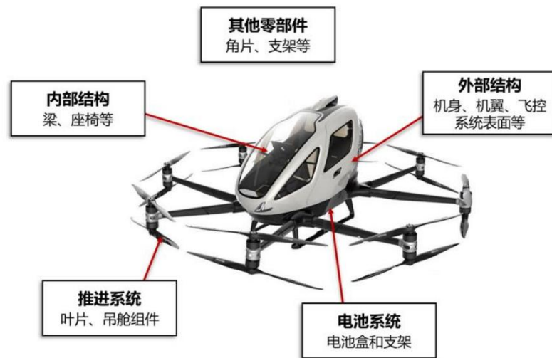
图62：复合材料几乎用于eVTOL的所有部件
