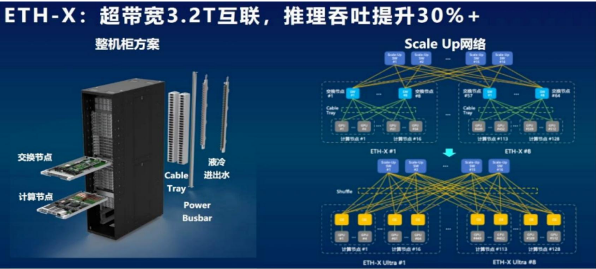
图：腾讯ETH-X架构
