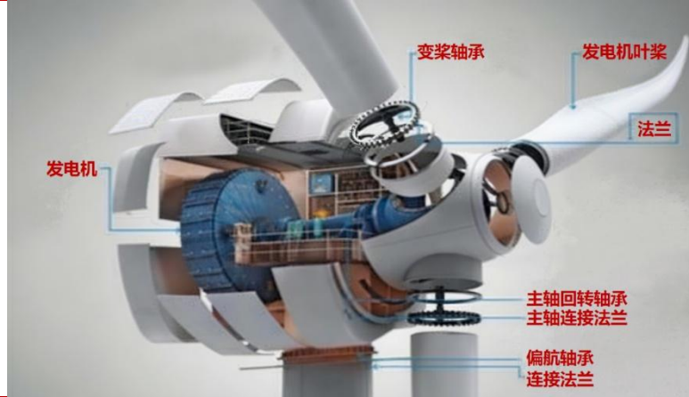
图36: 公司主要风电产品为风电轴承锻件、塔筒法兰、转子房等
