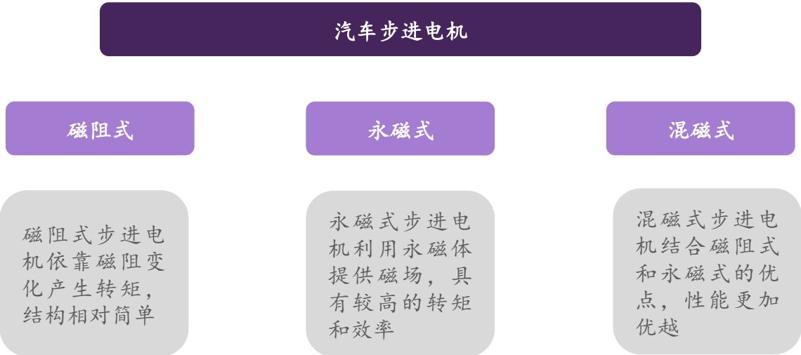
图表：汽车步进电机按励磁方式可分为磁阻式、永磁式和混磁式
