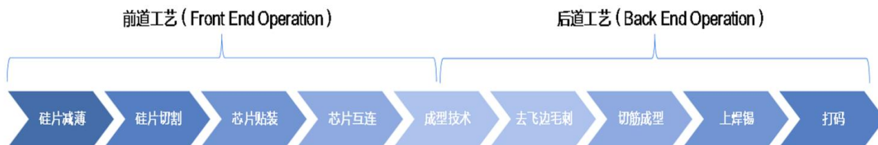
图表 18：芯片封装技术工艺流程
