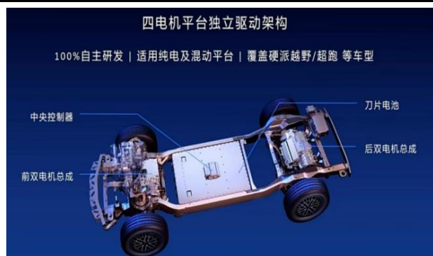
图6：四电机平台独立驱动架构
