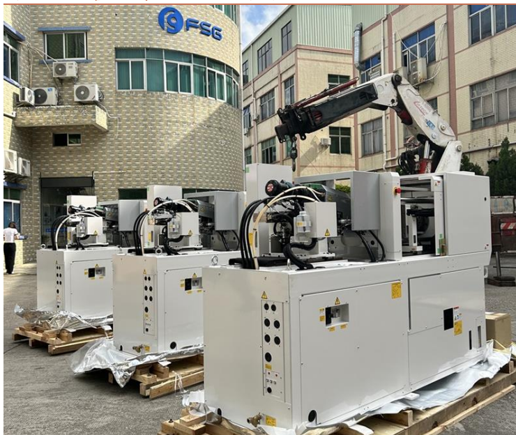
图7：福可喜玛生产 MT 插芯的成型机设备
