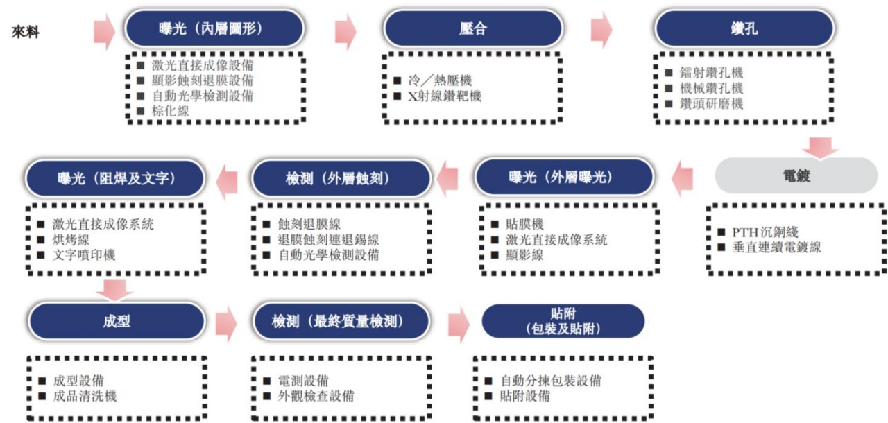
图18: PCB 主要生产工序
