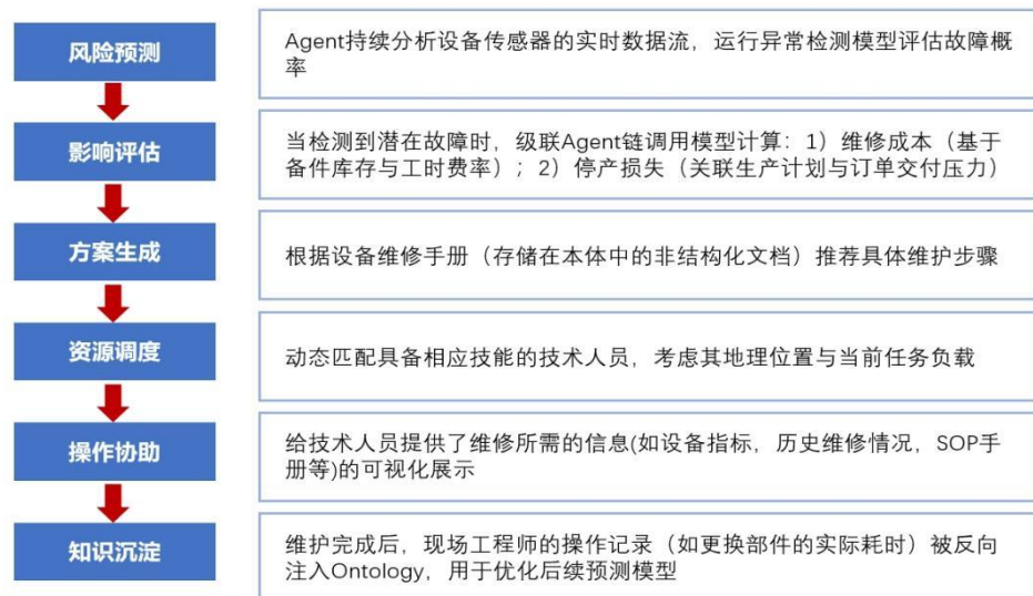
图 24: 生产设备的维护场景中 AIP 构建预测性维护体系流程
