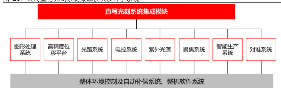
图 23：公司直写光刻系统集成模块及各子系统
