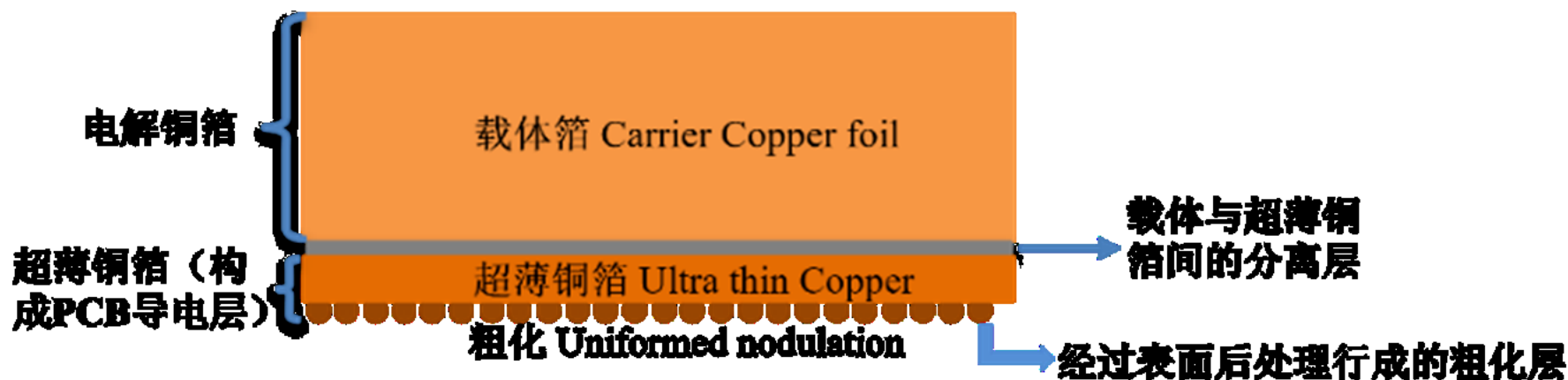
图：载体铜箔的产品结构
