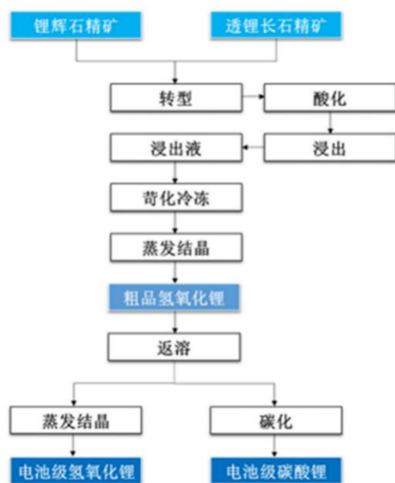
图9：电池级氢氧化锂和电池级碳酸锂制备工艺流程图
