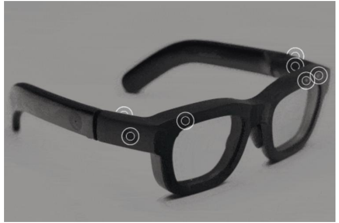
图表64: Meta Orion 的七个微型摄像头和传感器嵌入镜框边缘
