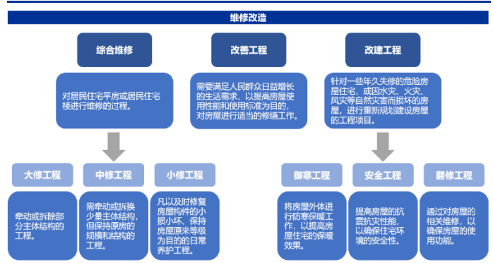
图 16: 房屋维修改造方式
