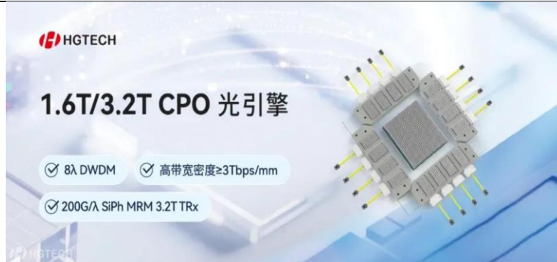
图2：华工正源发布并实时展示第二代基于微环调制器的 1.6T/3.2T CPO 光引擎
