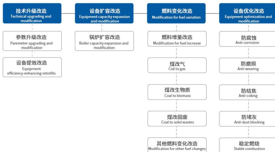
图16: 锅炉设备成套改造
