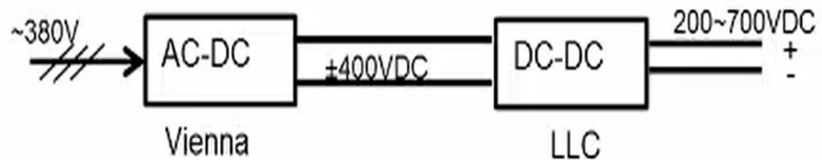
图 16: 电动车(EV)充电系统
