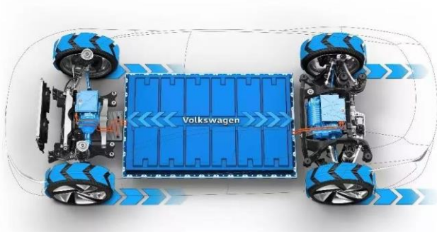
图32：MEB 平台是大众首款为大规模生产开发的电动车模块化平台
