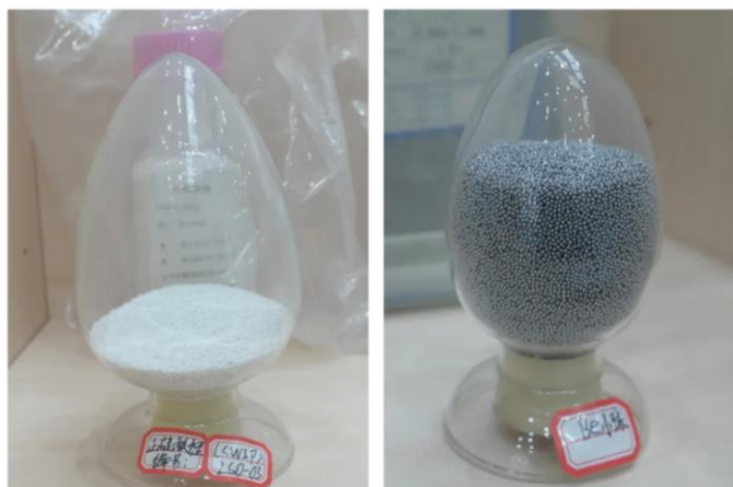
图46 氦增殖剂-正硅酸锂小球（左），中子倍增剂-铍小球（右）
