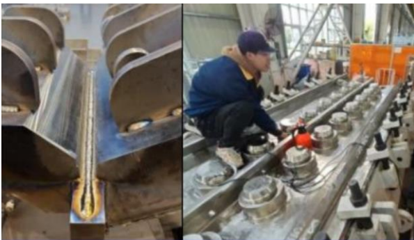
图57 电子束焊接和相控阵超声检测
