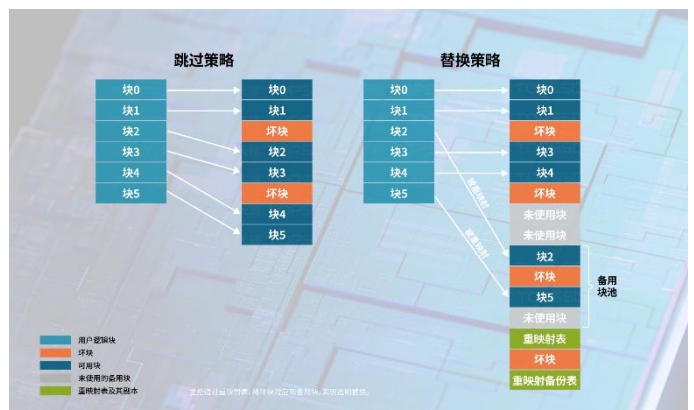
图93：主控芯片坏块管理示意
