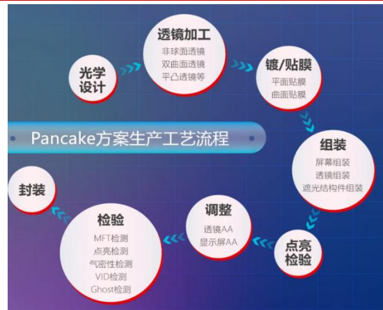
图26： Pancake 方案生产工艺流程
