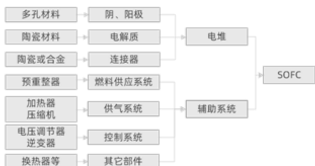
图表33：SOFC 系统结构组成：SOFC 系统包含电堆和辅助系统
