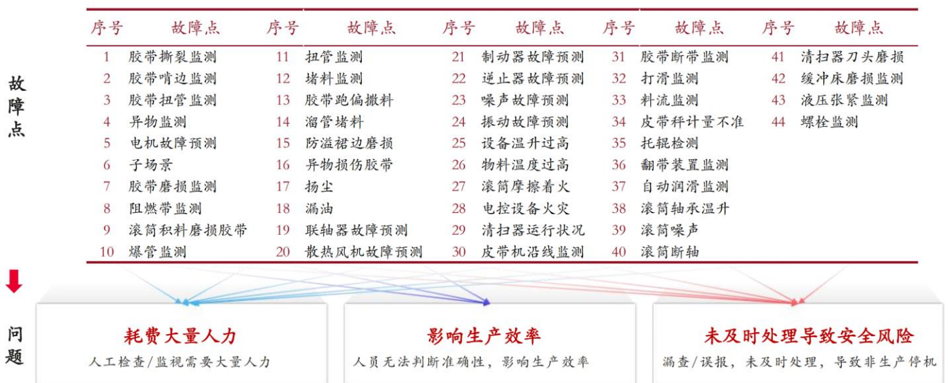
图 27：带式输送机运营故障点多，人工监视难度大，成本高
