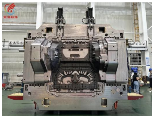
图27：文灿集团自主研发一体式大铸件模具
