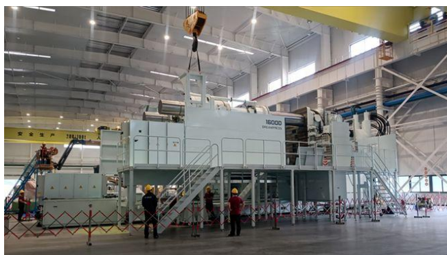
图26：广东鸿图与国内装备厂商联合研发 16000T 超大型智能压铸单元
