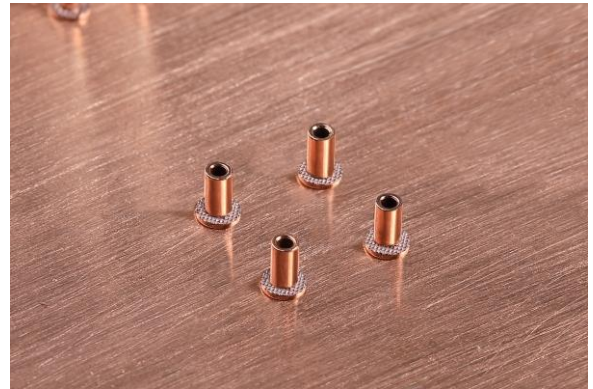
图24: 使用超声波焊接 pin 针与 DBC 基板结合良好
