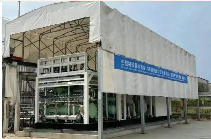
图28: 1t/hLNG 船用混合工质型再液化装置
