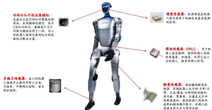
图14： 公司面向人形机器人领域布局的传感器，覆盖“触觉-平衡-力控-嗅觉”的多维产品矩阵
