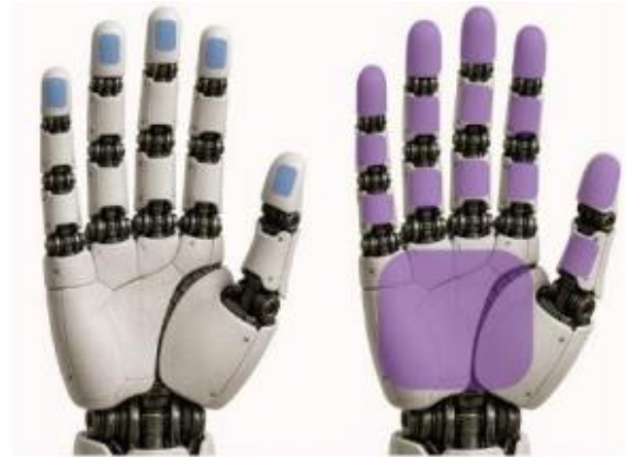
图15: 福莱新材柔性传感器在灵巧手的应用
