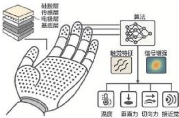
图14: 福莱新材柔性传感器在灵巧手的应用
