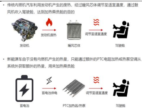
图 13: 燃油车 VS 新能源汽车制热原理
