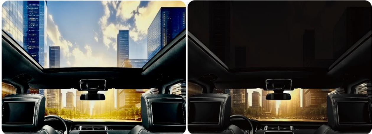
图 7: PDCLC 智能调光膜在 PDLC 技术基础上，引入了染料体系，可以实现黑色/彩色调光
