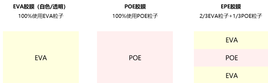
图 19:光伏胶膜根据使用材料和是否透明分为透明EVA、白色EVA、透明EPE、透明POE四种
