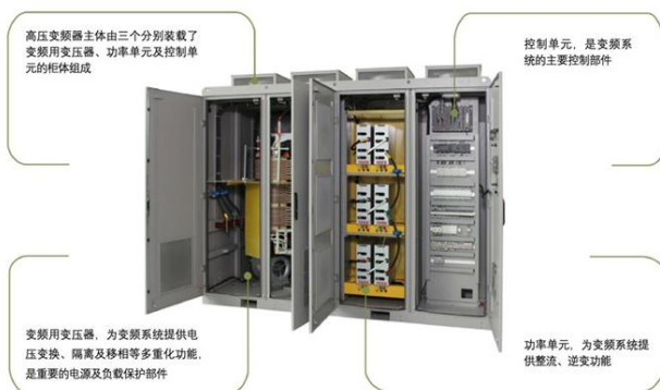
图 14：高压变频器的主要结构
