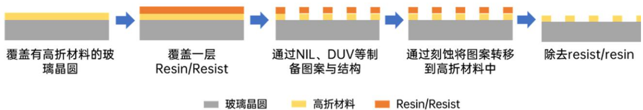
图 36:衍射光波导刻蚀工艺流程
