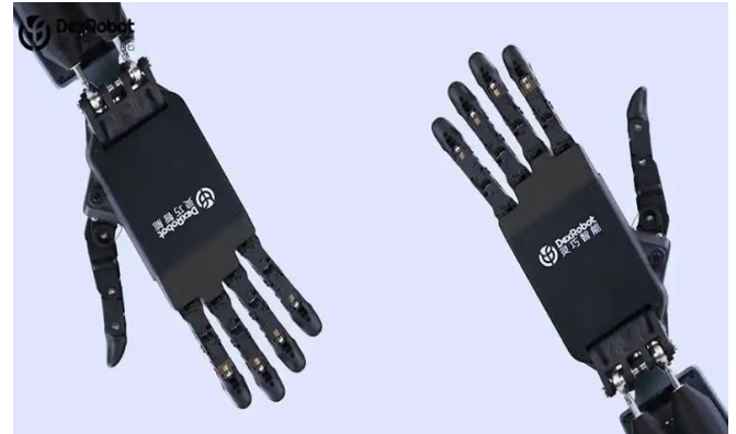
图28：灵巧智能的 DexHand021 Pro 采用双绳驱方案
