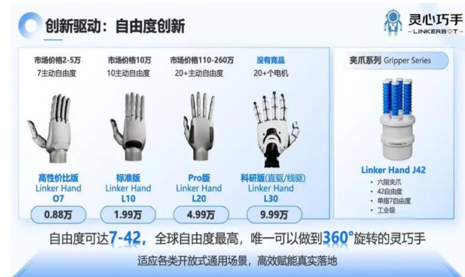
图27：灵巧手推出量产腱绳结构的灵巧手产品
