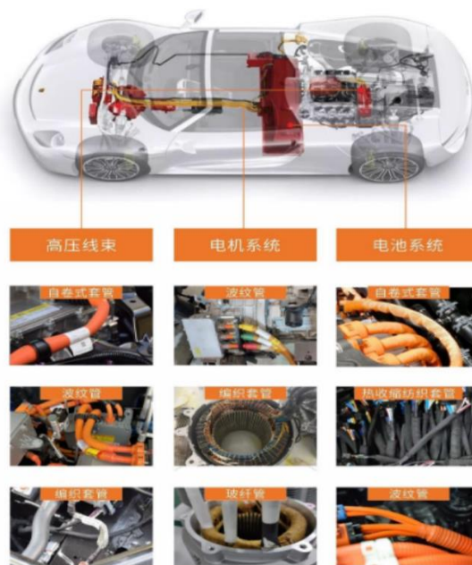
图14：功能性保护套管在新能源汽车的应用场景
