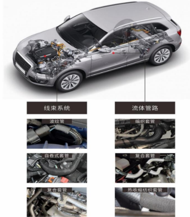
图11：功能性保护套管在燃油汽车的应用场景
