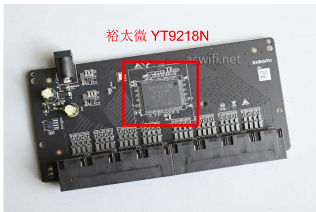
图28：小米千兆交换机 SW-108G 拆机
