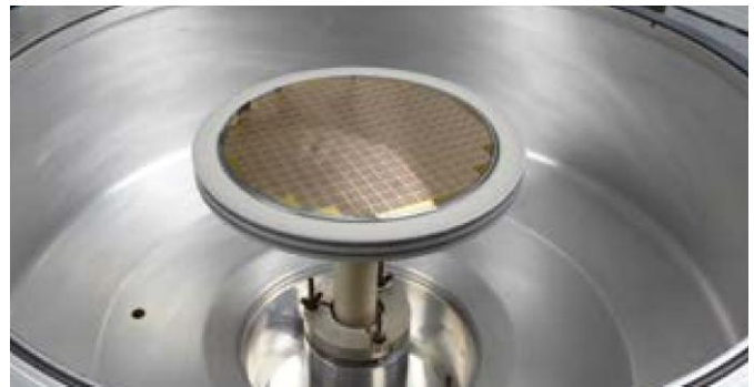
图 9: CVD 设备中的氧化铝陶瓷加热器
