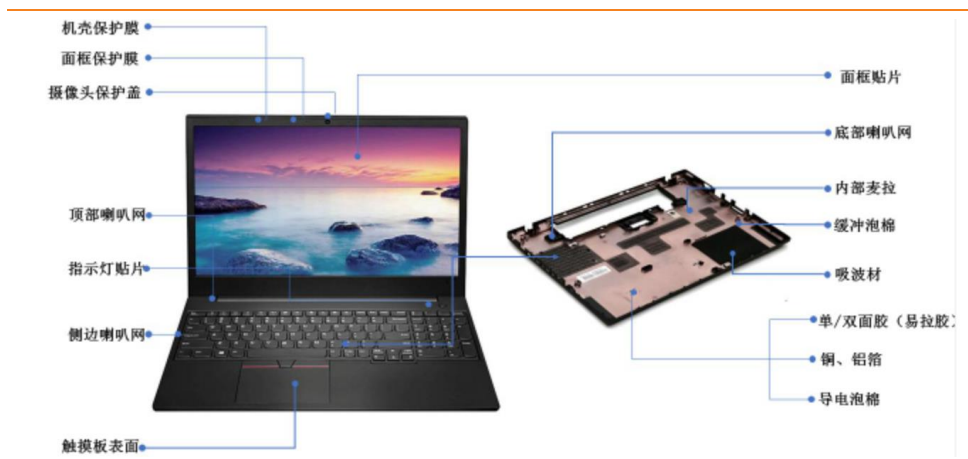
图 15：结构类功能性器件在笔记本中的应用
