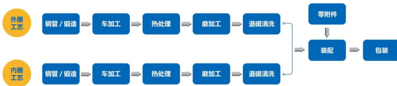
图 27：斯菱股份轴承加工工艺流程
