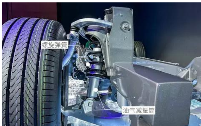
图9: 比亚迪仰望 U8 悬架系统采用螺旋弹簧+油气弹簧的复合弹簧结构
