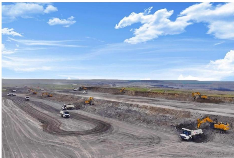
图8: 伊敏露天矿无人驾驶矿卡作业现场
