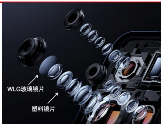
图 25 小米 MIX Fold4 采用玻塑混合镜头
