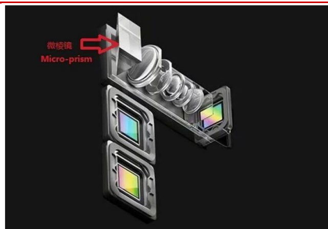
图 15 微棱镜在潜望式摄像头的应用示意图
