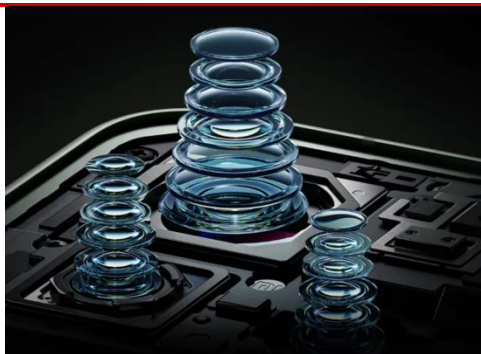
图 10 普通光学变焦模组内部架构示意图
