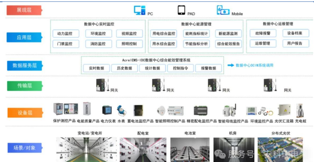
图表34: 安科瑞数据中心能效管理系统平台
