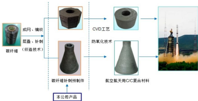
图 17：公司复合材料工艺示意图
