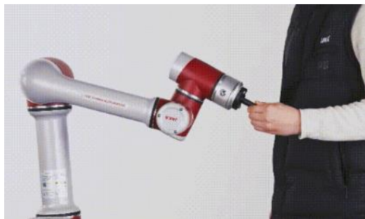
图 19 协作机器人手动引导示意图
