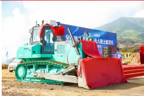
图25 山推全球首台 AI 纯电无人推土机
