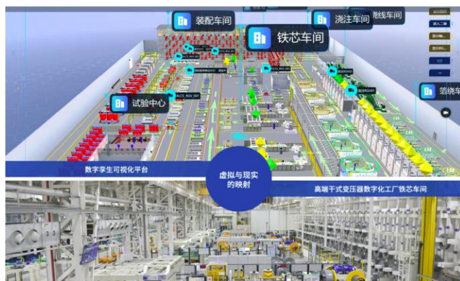
图表11：公司数字孪生可视化平台全面映射虚拟与现实（以铁芯车间为例）
