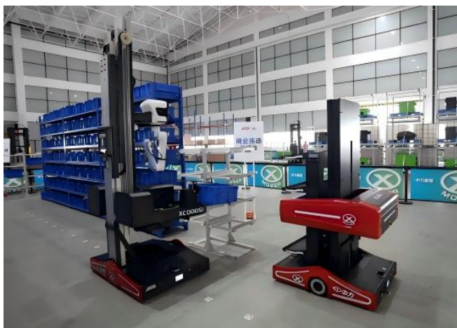
图46:具身智能拣料机器人，打通场内物料搬运最后一环
