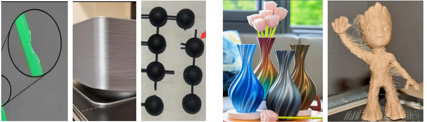
图表24: 耗材质量引发堵头(左)、翘边(中)、断裂(右) 图表25: 改性PLA耗材外观丰富(左丝绸料, 右木纹)
