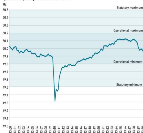
图表72：英国门迪储能系统5分钟内修复频率
